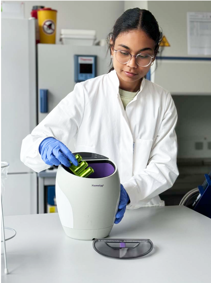
Sensible Instrumente und Gegenstände können ohne die Verwendung von Chemikalien mit Hilfe von Kaltem Plasma desinfiziert werden. Hierzu wurde das Gerät „CBC PlasmaEgg“ entwickelt. Bild: terraplasma
