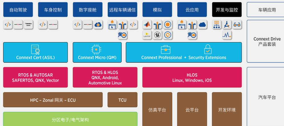
图1. RTI Connex Drive 软件堆栈
