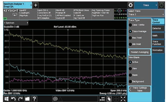
图 2-12b. 距载波频偏为 140 kHz 处的详细显示
