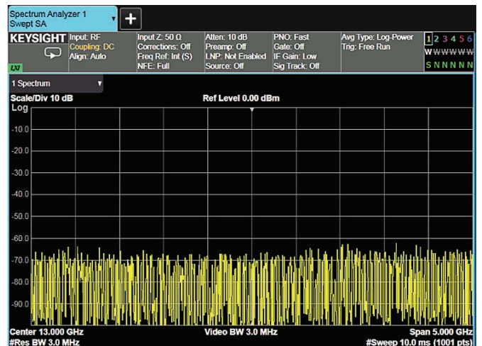
图 2-23b. 采样检波模式
