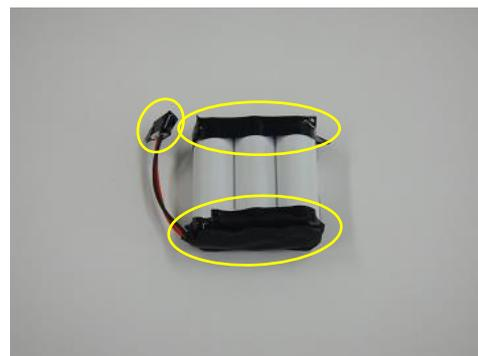
(電池端子連結部／コネクタ部の被覆)
