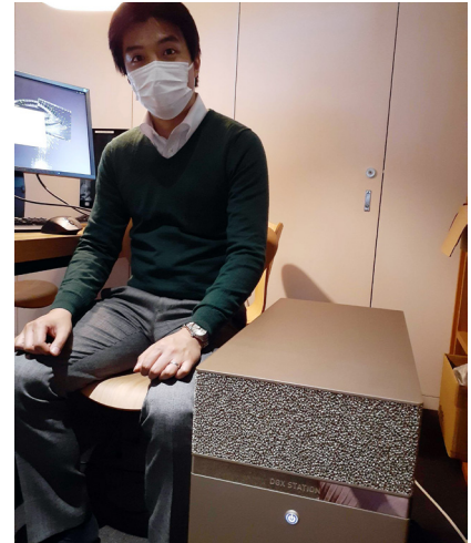
中山英樹研究室に導入された「NVIDIA DGX Station A100」は、GPUメモリが40GBの「NVIDIA A100」を4基搭載する
