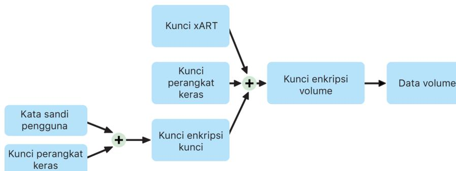
Di Mac dengan Apple silicon dan Mac dengan keping T2, semua penanganan kunci FileVault berlangsung di Secure Enclave; kunci enkripsi tidak pernah terpapar secara langsung ke CPU Intel. Secara default, semua volume APFS dibuat dengan kunci enkripsi volume. Konten volume dan metadata dienkripsi dengan kunci enkripsi volume ini, yang dibungkus dengan kunci enkripsi utama (KEK). KEK dilindungi oleh kombinasi kata sandi pengguna dan UID perangkat keras saat FileVault dinyalakan.
