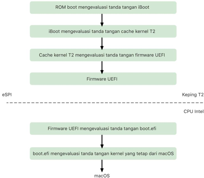
Setelah verifikasi, image firmware UEFI dipetakan ke bagian memori keping T2. Memori ini dibuat tersedia bagi CPU Intel melalui Antarmuka Periferal Serial yang ditingkatkan (eSPI). Saat melakukan boot untuk pertama kalinya, CPU Intel mengambil firmware UEFI melalui eSPI dari salinan firmware yang telah diperiksa integritasnya dan dipetakan ke memori, yang terdapat di keping T2.
