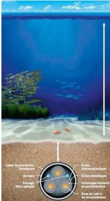
Câble électrique ensouillé
