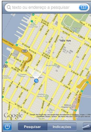
A aplicação Mapas utiliza o Norte geográfico para determinar a direcção em que se dirige, mesmo se tiver o Norte magnético definido na Bússola. Se a bússola necessitar de calibração, o iPhone pede-lhe que movimente o telefone, descrevendo um oito no ar. No caso de interferência, pode ter de se afastar da fonte da mesma. Consulte Capítulo 22, "Bússola," na página 184.
